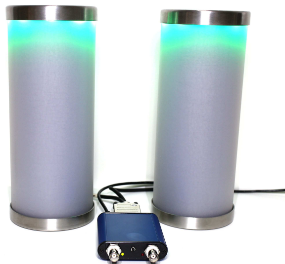
Рис. 2. Внешний вид pH прибора на основе системы MU3.0 и MU3.1 (без подключенных электродов).
