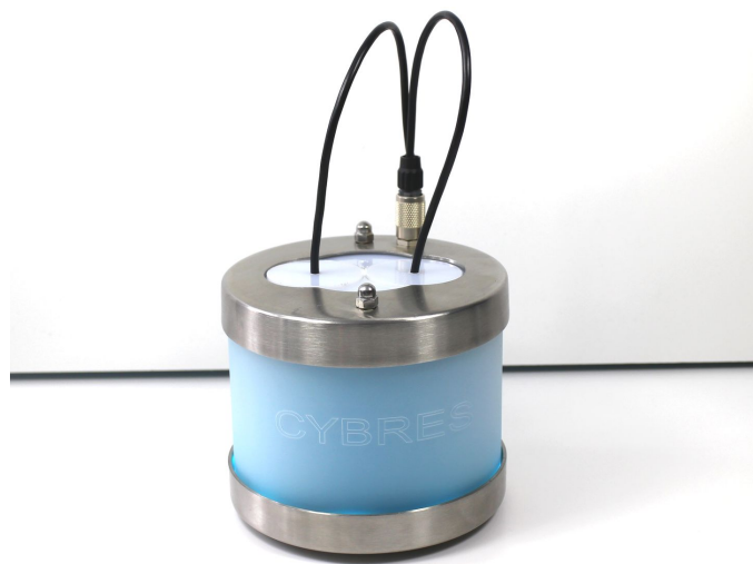
Рис. 5. Дифференциальный импедансный спектрометр на системе МУ EIS с температурной стабилизацией проб и электронных компонентов.
